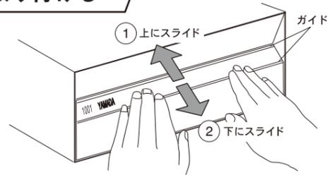
最初にお名前を記入した透明シートをガイドに押し当て、表面を指で軽く押しながら、ガイドの上の溝(上図参照)に透明シートが入るように上にスライドさせます。続いて、透明シートを押し当てたまま下にスライドさせ、セットします。次に部屋番号が記入された透明シートも同様の方法でガイドにセットしてください。
