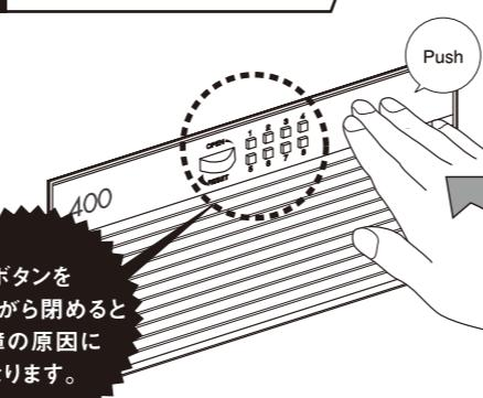
暗証番号の設定が完了したら、ボタンやツマミを避けて扉を手で押して閉め、“カチッ”と音がしてボタンがすべて復帰すれば自動的にロックされた状態になります。
